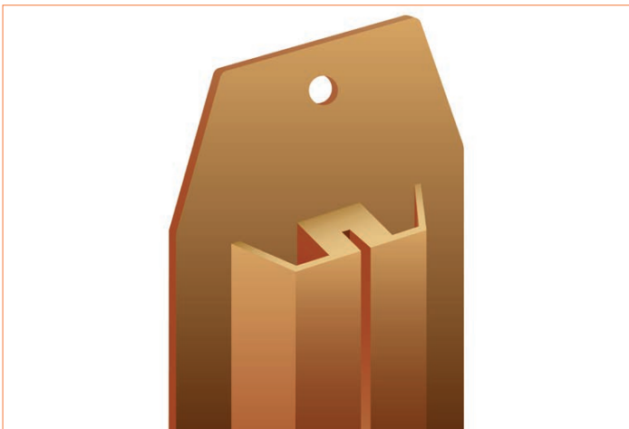
1. Spundwandelement mit Vorrichtung zum Einbau von Fugenband.
