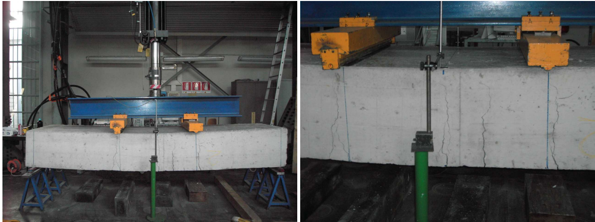
Figura 4.2.2 – Prova DRY 2: campione soggetto a carico massimo.
