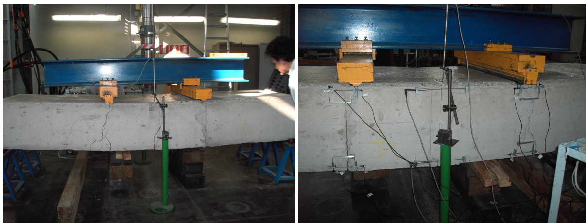
Figura 4.4.2 – Prova DRY 4: campione soggetto a carico massimo.
