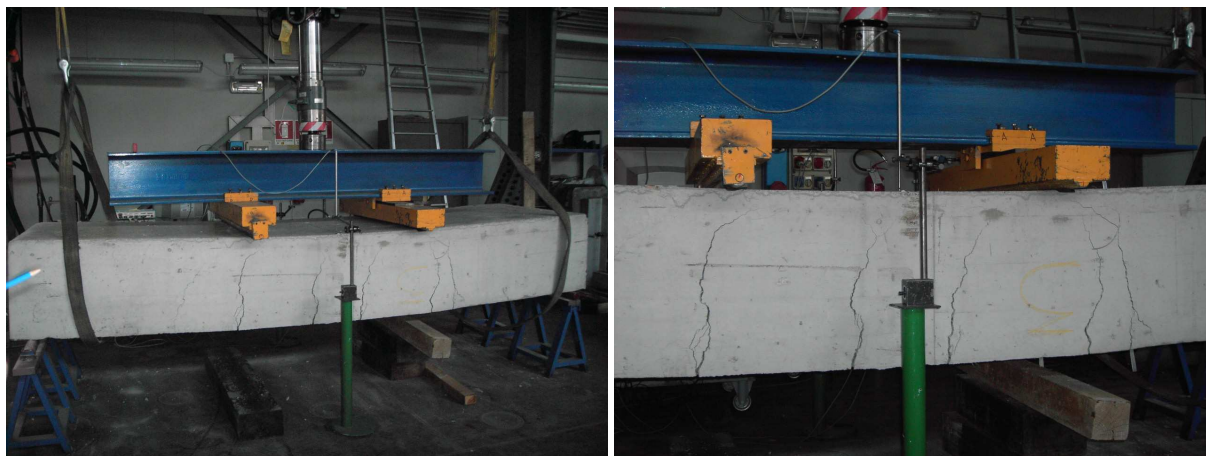
Figura 4.3.2 – Prova DRY 3: campione soggetto a carico massimo.
