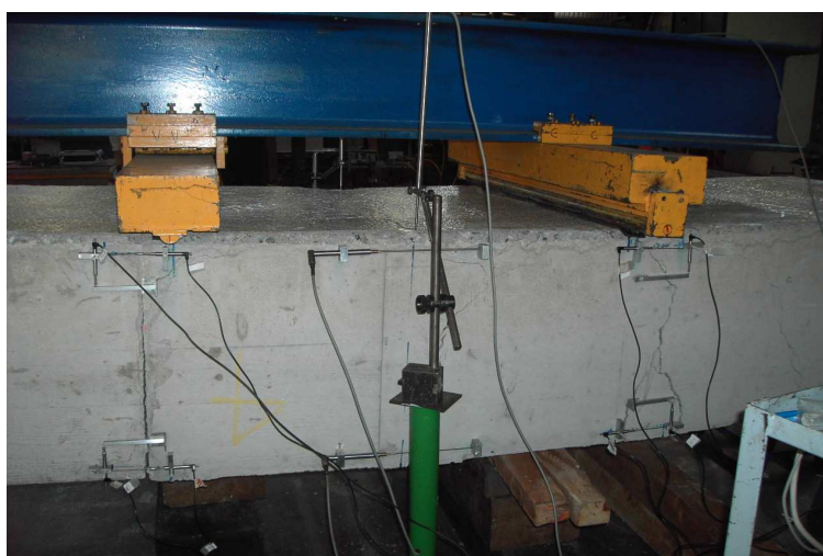
Figura 3.4 - Strumentazione sulla trave DRY4.
