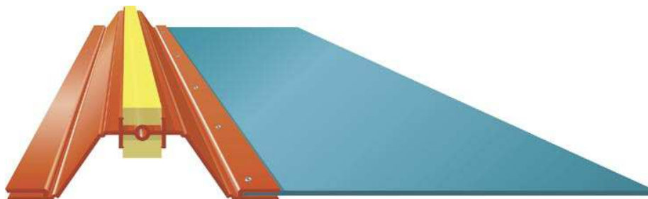
Figura 2.2-Geometria del giunto “Drytech” – Dryset EFP.
