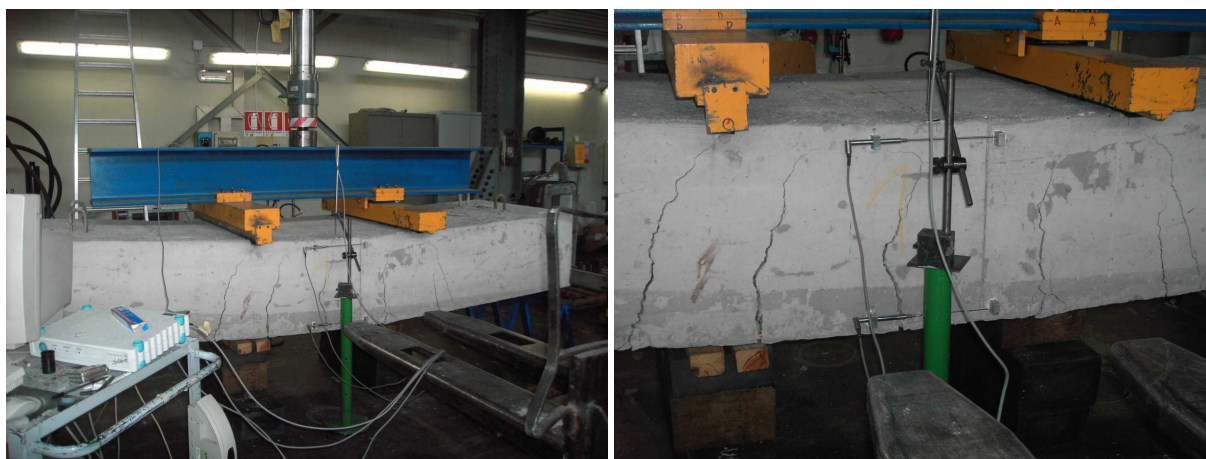
Figura 4.1.2 – Prova DRY 1: campione soggetto a carico massimo.
