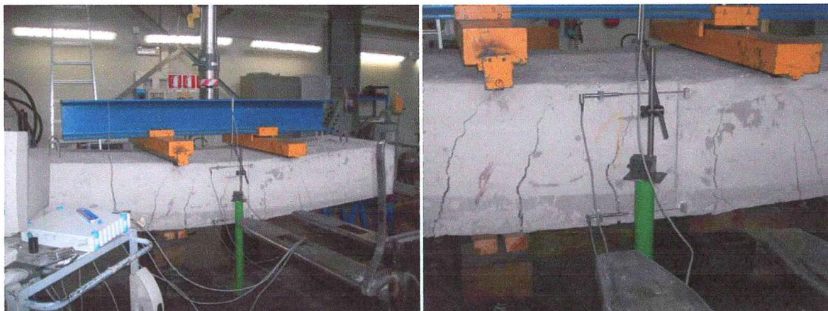
*Figura 5 – Prova DRY 1: campione soggetto a carico massimo.*
