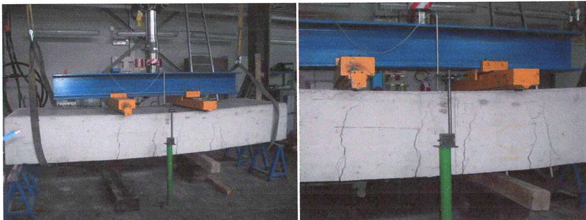
*Figura 9 – Prova DRY 3: campione soggetto a carico massimo.*
