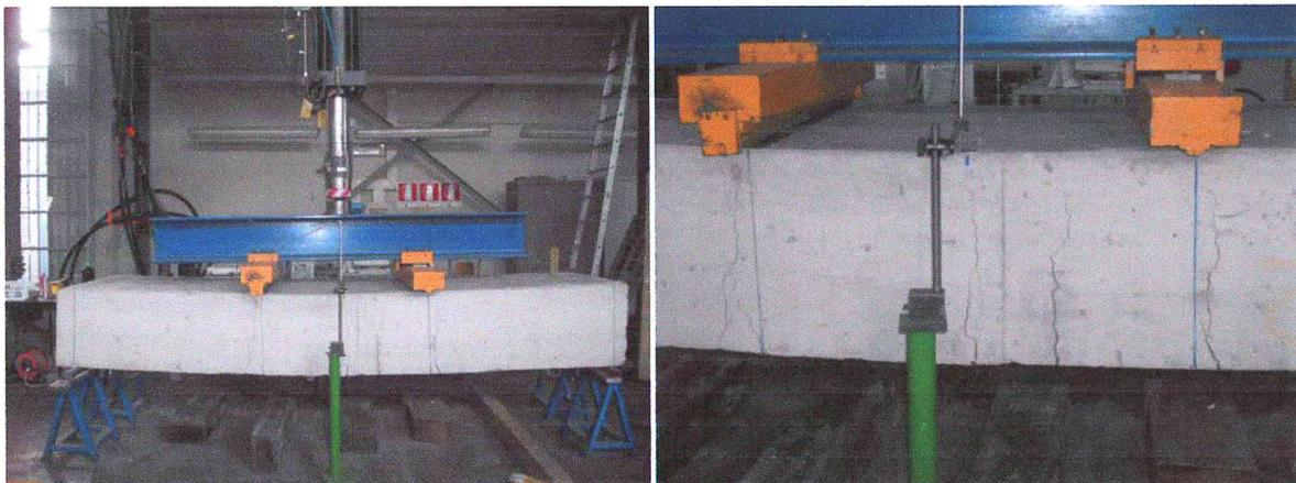
Figura 7 – Prova DRY 2: campione soggetto a carico massimo.
