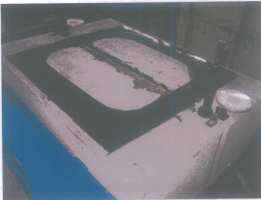
Bild 4: Prüfkörper während der Injektion des Polyurethanharzes mit sichtbarem Materialaustritt an der Oberseite des Risses
