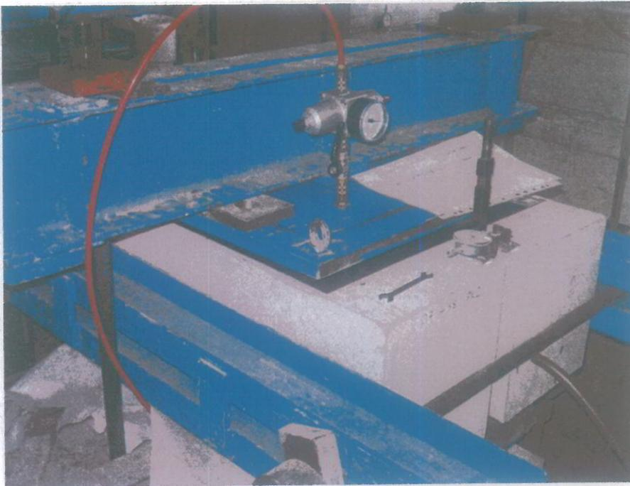
**Bild 5:** Mit Traversen verspannter Prüfkörper während der Dichtigkeitsprüfung bis 5 bar
