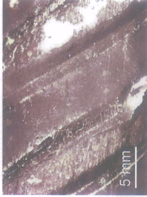
Quasi totale assenza di corrosione dell'armatura nella parte immersa direttamente nella resina
