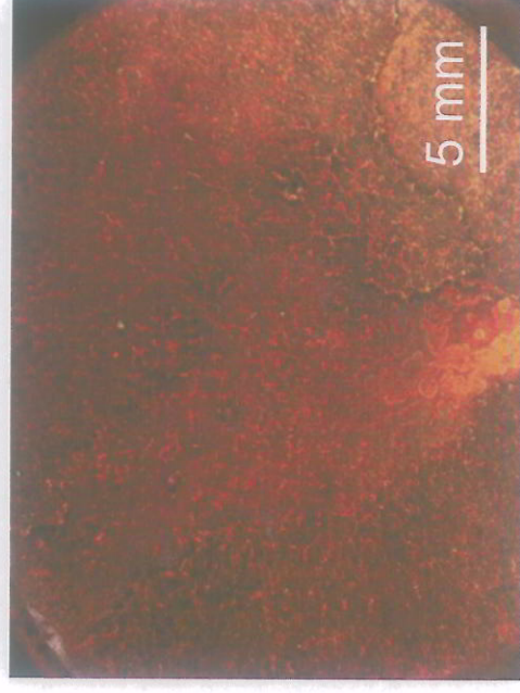
Strato di prodotti di corrosione sulla sezione superiore dell'armatura direttamente a contatto con la soluzione acquosa
