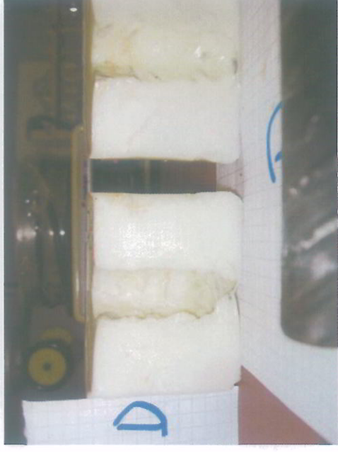
Assenza quasi totale di prodotti di corrosione (lieve colorazione rossastra nella parte alta della resina)
