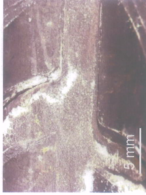
Quasi totale assenza di corrosione dell'armatura nella parte a contatto con la soluzione acquosa
