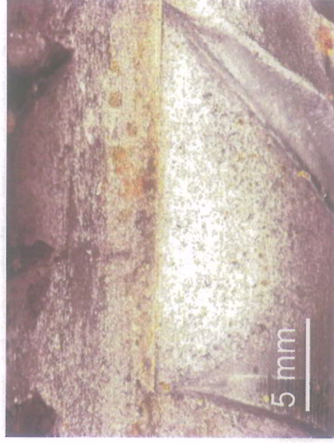
Presenza sporadica di prodotti di corrosione Sull'armatura direttamente immersa nella resina
