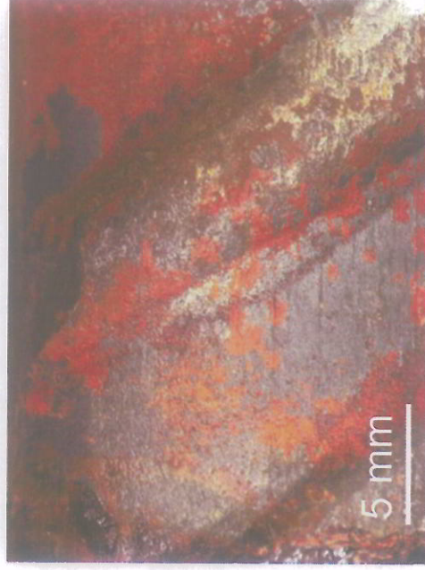
Corrosione dell'armatura nella parte immersa direttamente nella resina
